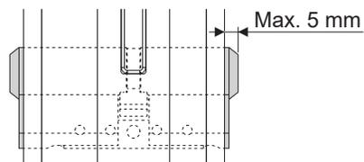
Remarque : Le cylindre ne doit pas dépasser de plus de 5 mm de la porte ou de la serrure.
