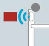
SMARTair Standalone ermöglicht Ihnen das einfache Hinzufügen und Löschen von Benutzern über die rote Programmierkarte. Mit der Funktion „Shadow card“ müssen nicht alle Karten gelöscht werden, wenn eine verloren geht.
