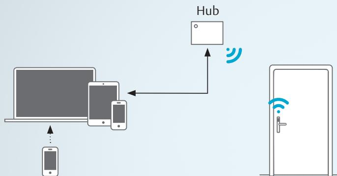
Die Kommunikation zwischen Türvorrichtungen und Systemsoftware wird von Hubs automatisiert und verschlüsselt. Jeder Hub verwaltet bis zu 30 Türen in einer Reichweite von 30 Metern. Im Falle eines Kommunikationsausfalls wird die Funktionalität mit den neuesten gespeicherten Daten offline aufrechterhalten.
